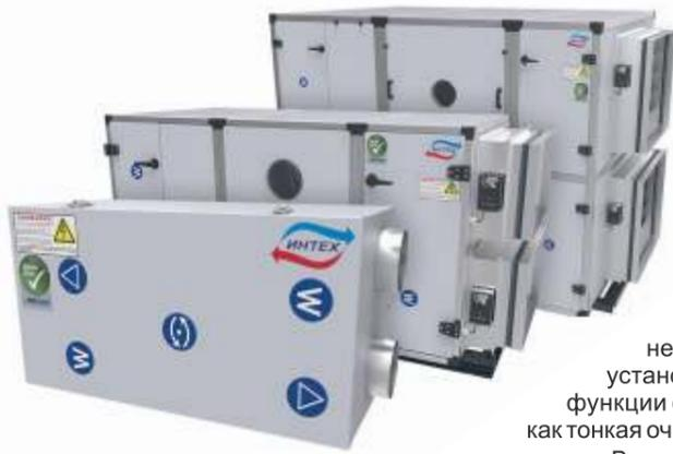
**Приточно-вытяжные вентиляционные установки с роторным рекуператором тепла серии ВУ/МВУ** применяются для подачи свежего уличного воздуха в жилые, общественные и промышленные помещения, а также удаления отработанного воздуха из них. При этом основной особенностью указанных установок является наличие в их корпусе роторного рекуператора, который передает тепло от вытяжного воздуха к приточному, за счет чего экономится до 85 процентов энергии, которая используется для обогрева помещения.
